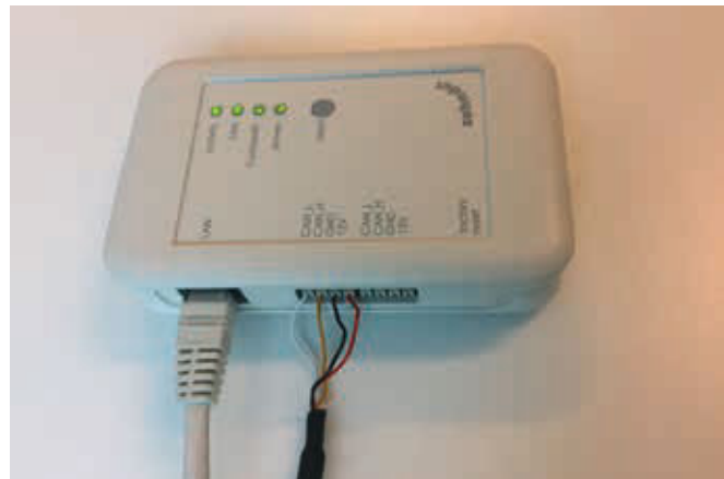
Bloc de jonction ComfoAir Q pour connexion/alimentation ComfoConnect LAN C
